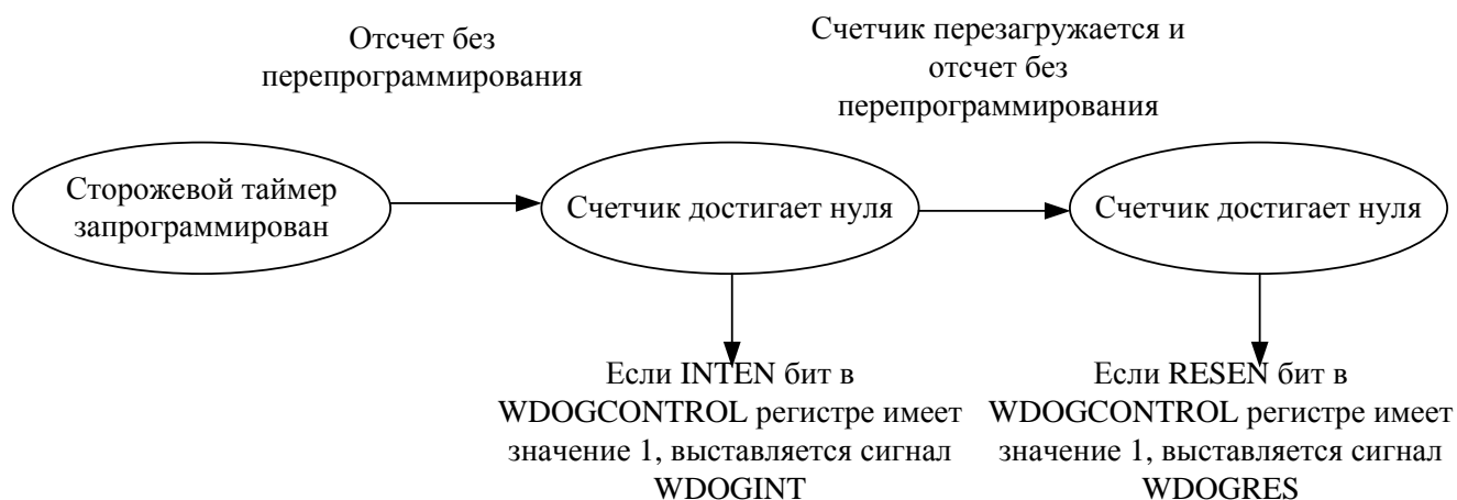
Рисунок 3.14.1 — Диаграмма состояний сторожевого таймера
